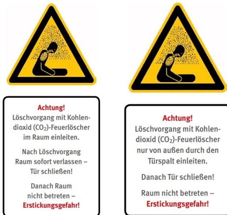
Abbildung 17: Hinweisschilder für den Einsatz von CO<sub>2</sub>-Löschgeräten
